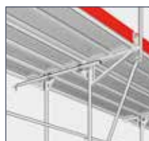
Tubo de anclaje con dos grapas para anclar el marco.
